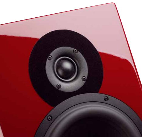
Zur Vermeidung von Kantenreflexionen umgibt den Hochtöner ein Ring aus Filz
